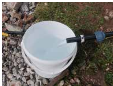
Wasserzulauf am Ingolstädter Haus, durch die Verlegung neuer Sammelleitungen an Quelfassung betrug der Zulauf 20m³ in 24 Std.
